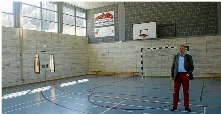
Die neuen Prallwände sowie eine moderne Deckenheizung geben der umgebauten Nusplinger Turn- und Festhalle ein gewisses Flair.
